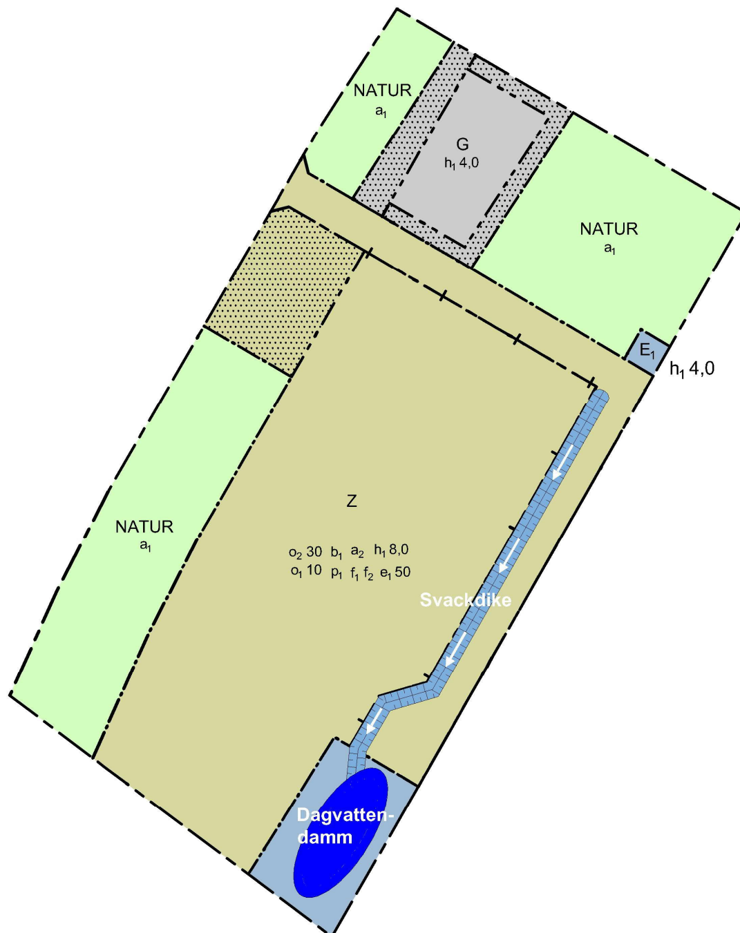
Figur 16. Situationsplan med föreslagna åtgärder i form av dagvattendamm och svackdike för omhändertagande av dagvatten.
